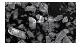
Poudre de polissage à air conventionnelle Diamètre moyen des particules : 73 µm Vue au microscope électronique à balayage - Grossissement x150
