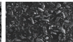
Poudre Perio-Mate Diamètre moyen des particules : 25 µm Vue au microscope électronique à balayage - Grossissement x150
